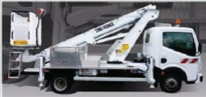
Nacelle élévatrice sur châssis d'une hauteur de travail de 16,50m
