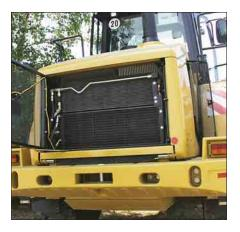
Circuit de refroidissement. L'accès pour le nettoyage et l'entretien est sans égal. La calandre perforée et ondulée minimise les accumulations de débris et pivote pour faciliter le nettoyage et l'accès aux faisceaux de refroidissement.
