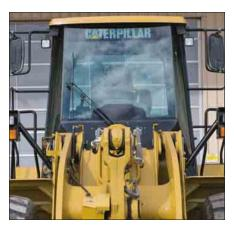
**Cabine.** Il faut environ 45 minutes pour déposer entièrement le poste de conduite. Ce dernier peut ensuite être facilement remonté. Des raccords rapides sont utilisés, ainsi aucun fil ne doit être coupé et il n'y a aucune perte de réfrigérant.
