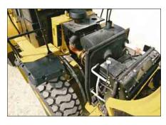
Un vérin unique de levage mécanique, qui peut être actionné manuellement, permet d'ouvrir le capot. Le capot inclinable offre un très bon accès au compartiment moteur et, au besoin, l'ensemble du capot peut être déposé avec les points de levage intégrés. Capot fermé, des contrôles rapides du niveau d'huile moteur et du regard de niveau de liquide de refroidissement peuvent être effectués par les portes d'entretien latérales.
