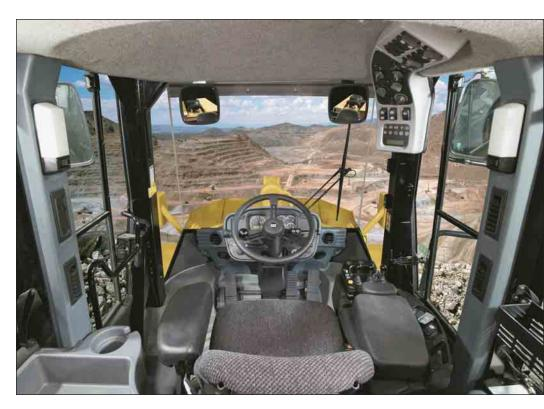
Les commandes d'équipement montées sur le siège à suspension pneumatique réduisent les vibrations verticales qui passent par le plancher de la cabine.
