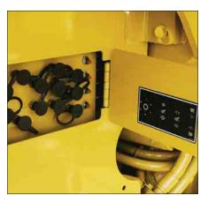
**Prises de pression à distance.** Des prises de pression pour les circuits hydraulique et de direction, la transmission (en option) et les freins sont regroupées derrière un panneau de visite, juste sous la plate-forme d'entretien de droite.
