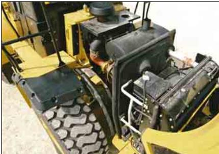
Un vérin unique de levage mécanique, qui peut être actionné manuellement, permet d'ouvrir le capot. Le capot inclinable offre un très bon accès au compartiment moteur et, au besoin, l'ensemble du capot peut être déposé avec les points de levage intégrés. Capot fermé, des contrôles rapides du niveau d'huile moteur et du regard de niveau de liquide de refroidissement peuvent être effectués par les portes d'entretien latérales.
