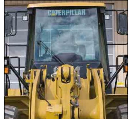
**Cabine.** Il faut environ 45 minutes pour déposer entièrement le poste de conduite. Ce dernier peut ensuite être facilement remonté. Des raccords rapides sont utilisés, ainsi aucun fil ne doit être coupé et il n'y a aucune perte de réfrigérant.
